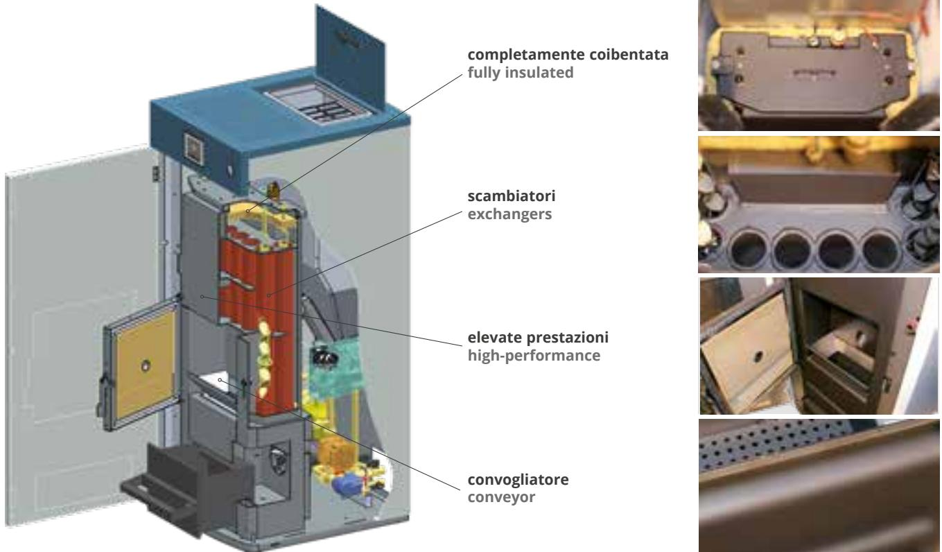
Gli speciali **scambiatori** in acciaio trasmettono il calore all'acqua con un'ottima resa, per conduzione e irraggiamento della fiamma e per convezione attraverso il percorso che compiono i fumi. La disposizione del fascio tubiero è stata concepita per garantire il massimo scambio termico a diretto contatto con la fiamma e i fumi in uscita per la migliore efficienza termica.
