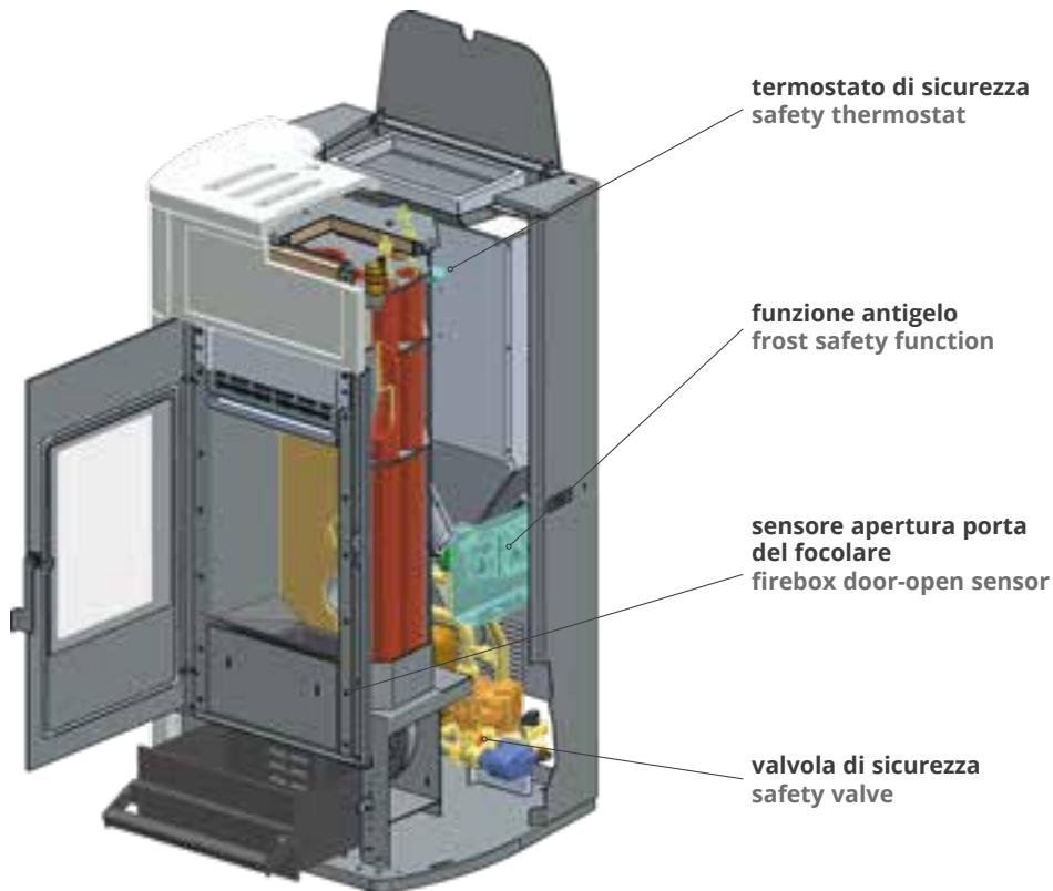
La funzione di sicurezza **antigelo** avvia automaticamente il circolatore della stufa se l'acqua della caldaia scende sotto i 5 gradi, affinché il congelamento non comprometta la stufa e l'impianto termico.
