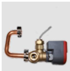
Kit optional, in sagoma del prodotto composto da una valvola anticondensa e da una sonda di ritorno. Nei casi in cui ci possa essere un ritorno di acqua troppo fredda dall'impianto verso il prodotto, il dispositivo con l'ausilio della sonda di ritorno, previene la formazione di condensa all'interno della camera di combustione e dei fasci tubieri.
