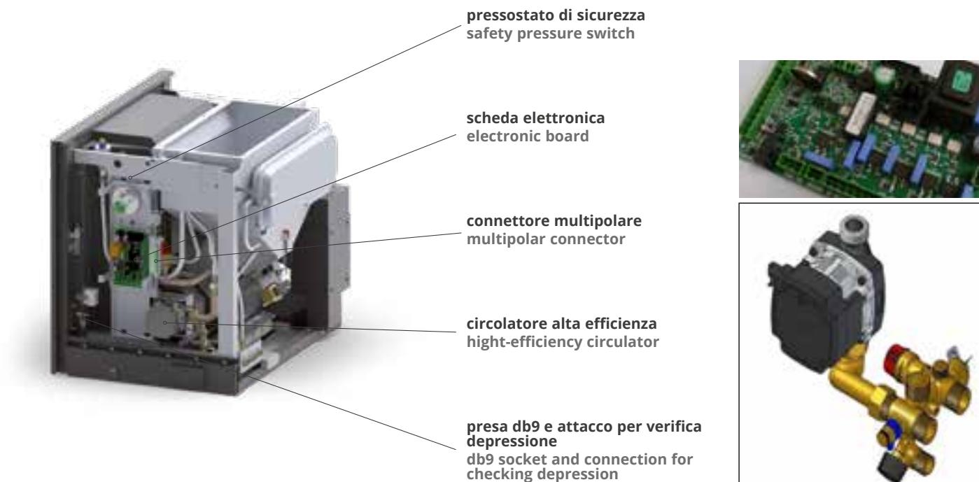
Il circolatore ad **alta efficienza a controllo elettronico** di serie, assicura massima flessibilità di installazione. Può essere tarato in base alle esigenze dell'impianto termoidraulico scegliendo direttamente dal display tra **4 impostazioni** che determinano la portata dell'acqua. Regola la quantità d'acqua immessa nell'impianto in base alla temperatura dell'acqua in caldaia. A prodotto spento, ma collegato alla rete elettrica si attiva settimanalmente per evitare blocchi.
