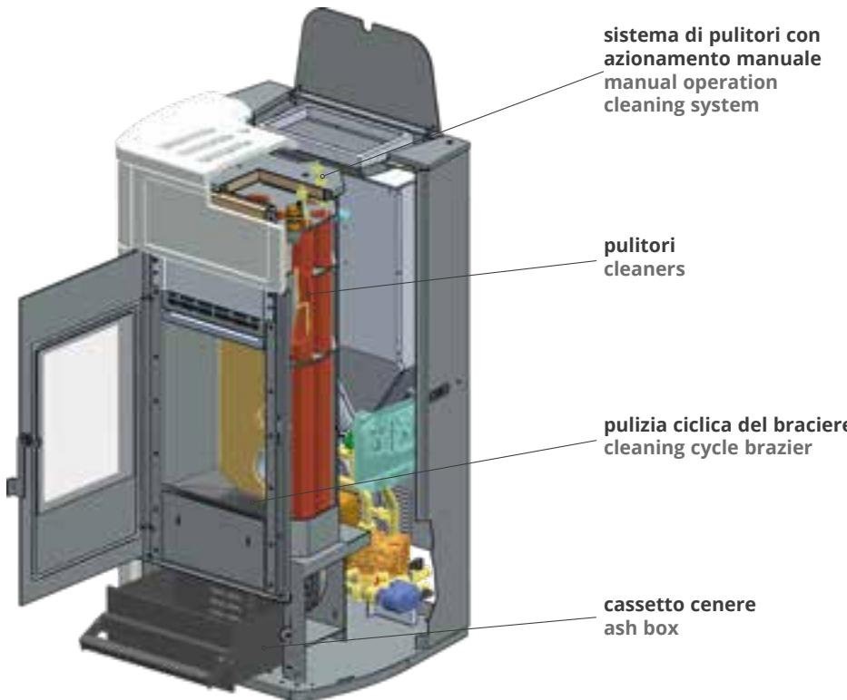
È sufficiente, dopo ogni rifornimento del pellet, un semplice **azionamento manuale** dall'esterno del sistema senza dover rimuovere alcun componente, che con una manopola mette in rotazione i **pulitori** all'interno dello scambiatore. Il **sistema ciclico di pulizia del braciere** in fase di funzionamento ottimizza combustione e rendimenti.
