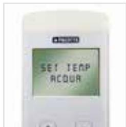
La gestione elettronica prevede l'impostazione della temperatura dell'acqua desiderata in caldaia o ambiente. L'elettronica monitora lo stato di funzionamento del monoblocco e gestisce la combustione in base alle effettive richieste dell'impianto in tempi brevi e veloci. Si ottiene una ottimizzazione della combustione e dei consumi.
