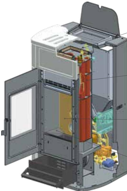
Gli speciali **scambiatori** in acciaio trasmettono il calore all'acqua con un'ottima resa, per conduzione e irraggiamento della fiamma e per convezione attraverso il percorso che compiono i fumi. La disposizione del fascio tubiero è stata concepita per garantire il massimo scambio termico a diretto contatto con la fiamma e i fumi in uscita per la migliore efficienza termica.
