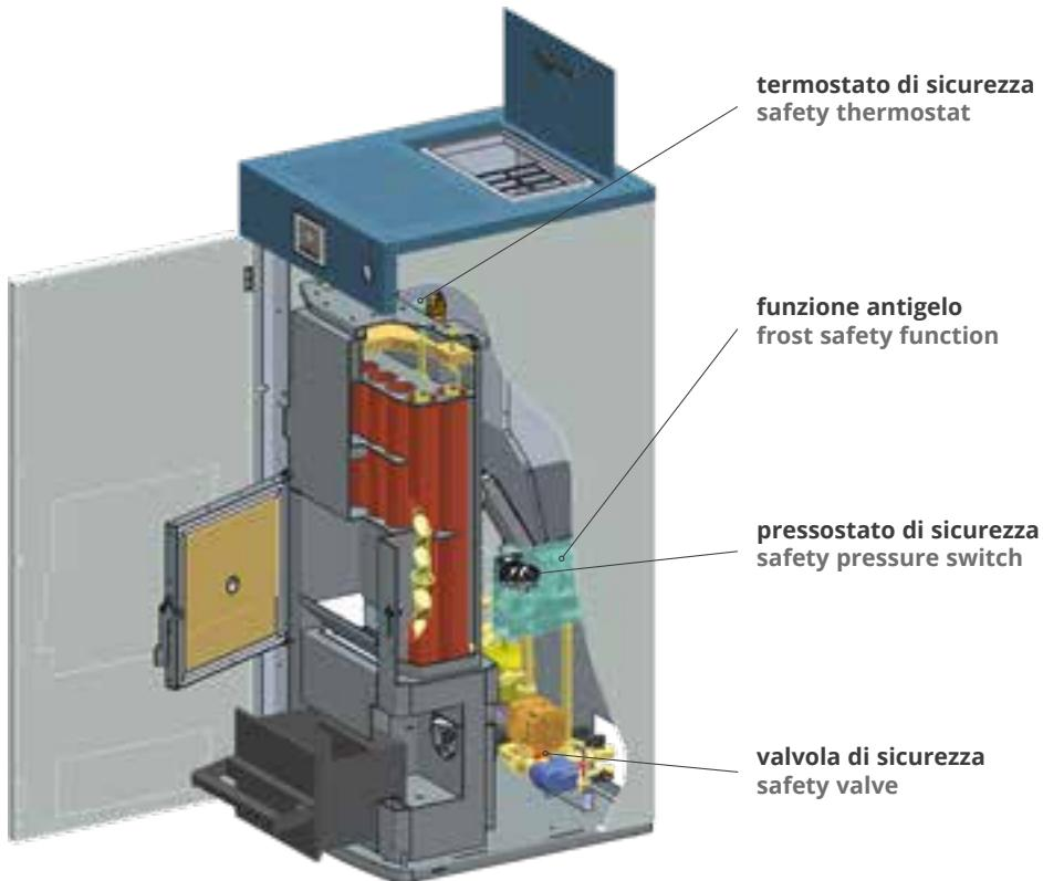
La funzione di **sicurezza antigelo** avvia automaticamente il circolatore del monoblocco se l'acqua della caldaia scende sotto i 5 gradi, affinché il congelamento non comprometta la caldaia e l'impianto termico. La **valvola di sicurezza** a 3 bar per il controllo della pressione, permette di utilizzare il monoblocco in totale sicurezza.
