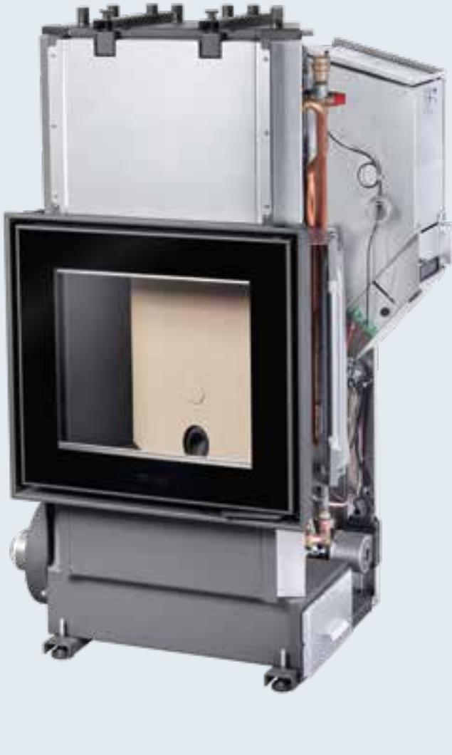
Monoblocco in acciaio verniciato di notevole spessore con focolare chiuso. Focolare in acciaio e Aluker®, deflettore fumi in Scamolex, braciere in acciaio refrattario, convogliatore in acciaio. Sistema di pulizia dello scambiatore ad elementi rotanti. Vaso di espansione e circolatore ad alta efficienza di serie. Porta in ghisa e maniglia a scomparsa apribile con manofredda.
