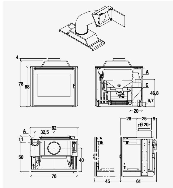
**Serbatoio pellet caricamento frontale o laterale**
