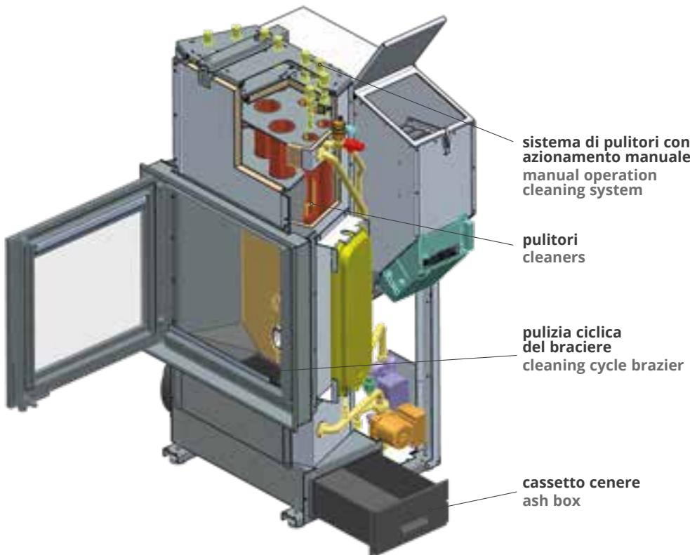
È sufficiente, dopo ogni rifornimento del pellet, un semplice **azionamento manuale** dall'esterno del sistema senza dover rimuovere alcun componente, che con una manopola mette in rotazione i **pulitori** all'interno dello scambiatore. Il **sistema di pulizia ciclico del braciere** in fase di funzionamento ottimizza combustione e rendimenti. La normale manutenzione, da compiere a freddo, è così più comoda e pratica.
