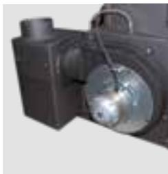
Motore fumi con Encoder per una velocità costante in ogni condizione di funzionamento anche in caso di sbalzi di tensione o differenze di pressione nella canna fumaria. Chiocciola in ghisa, resistente alla corrosione dei residui di combustione per una lunga durata nel tempo.
