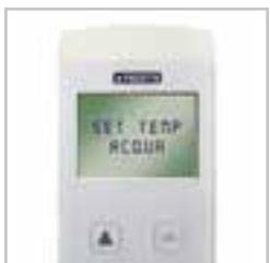
La gestione elettronica prevede l'impostazione della temperatura dell'acqua desiderata in caldaia o ambiente. L'elettronica monitora lo stato di funzionamento della stufa e gestisce la combustione in base alle effettive richieste dell'impianto in tempi brevi e veloci. Si ottiene una ottimizzazione della combustione e dei consumi.
