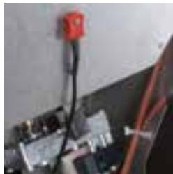
Il livello del pellet in alcuni modelli viene costantemente monitorato da un sensore posizionato nel serbatoio che consente di controllare in tempo reale il contenuto di pellet e segnalare il livello minimo sul display del telecomando.
