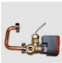
Kit optional composto da una valvola anticondensa e da una sonda di ritorno. Nei casi in cui ci possa essere un ritorno di acqua troppo fredda dall'impianto verso il prodotto, il dispositivo con l'ausilio della sonda di ritorno, previene la formazione di condensa all'interno della camera di combustione e dei fasci tubieri.
