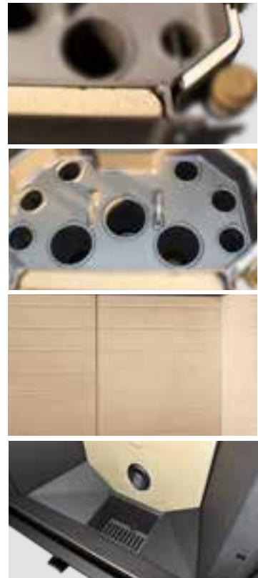
Il **convogliatore** nel braciere consente durante il funzionamento che la cenere che si deposita ai bordi delle pareti possa ricadere all'interno del braciere ed essere nuovamente bruciata. Questo oltre ad ottimizzare la combustione riduce il volume dei residui di incombusto fino a circa l' 80%, ottenendo **elevati rendimenti**, si rendono inoltre più lunghi gli intervalli tra una pulizia e l'altra.
