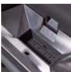
Il convogliatore nel braciere consente, durante il funzionamento, che la cenere che si deposita ai bordi delle pareti possa ricadere all'interno del braciere ed essere nuovamente bruciata. Questo oltre ad ottimizzare la combustione riduce il volume dei residui di incombusto fino a circa l' 50%, ottenendo elevati rendimenti, si rendono inoltre più lunghi gli intervalli tra una pulizia e l'altra.
