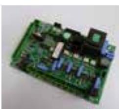
Una sofisticata scheda elettronica garantisce il costante monitoraggio della stufa attraverso la gestione e la verifica dei parametri di funzionamento. Un'attività continua che garantisce la resa ottimale del prodotto, in linea con le effettive esigenze dell'impianto termico, evitando così spreco di combustibile e ottimizzando al massimo le caratteristiche della stufa.
