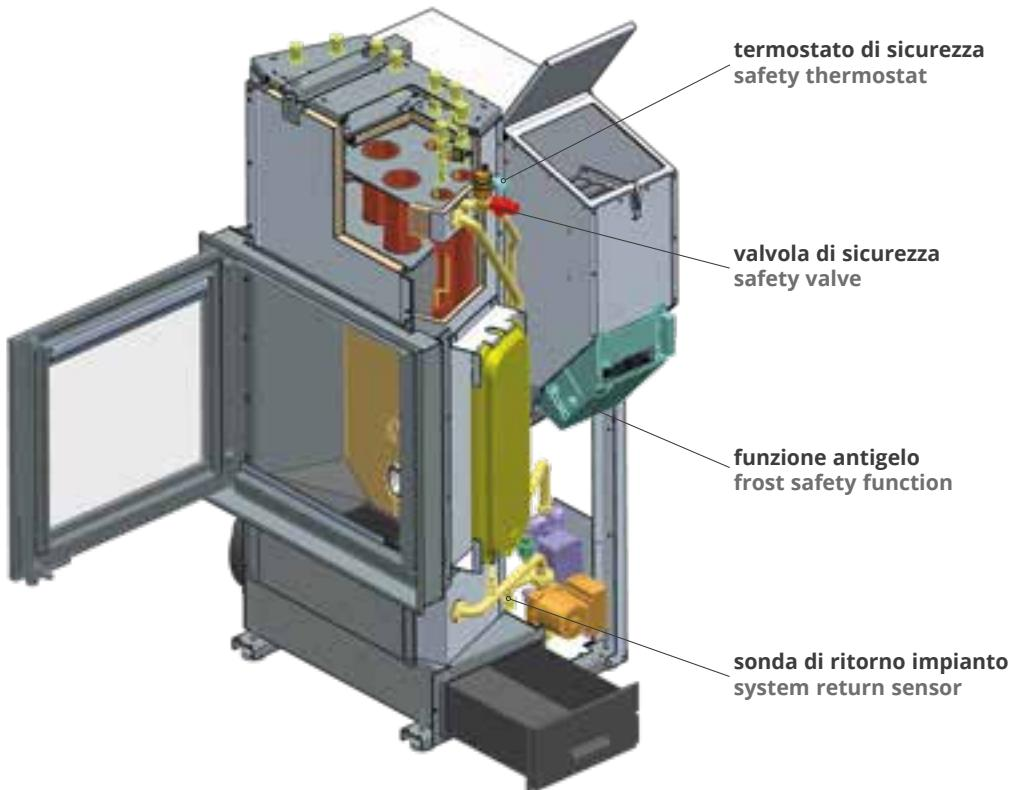
La funzione di **sicurezza antigelo** avvia automaticamente il circolatore del monoblocco se l'acqua della caldaia scende sotto i 5 gradi, affinché il congelamento non comprometta il monoblocco e l'impianto termico.
