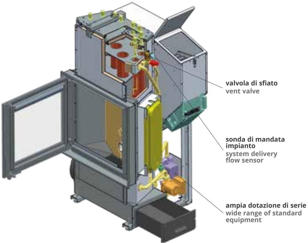
La **sonda di mandata impianto** rileva la temperatura dell'acqua in mandata della caldaia **gestendo in base a questo ben 16 diversi livelli di potenza**. Gli intervalli minimi tra le potenze dei diversi livelli assicurano una piacevole visione della fiamma non essendo soggetta ad improvvisi sbalzi.
