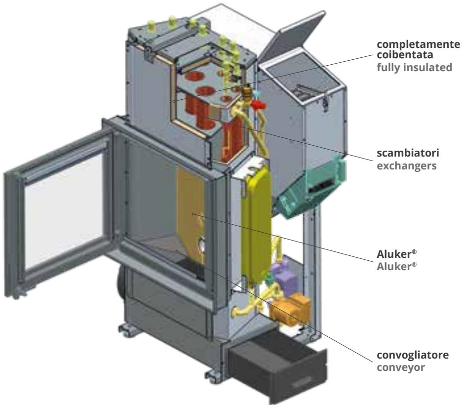
Gli speciali **scambiatori** in acciaio trasmettono il calore all'acqua con un'ottima resa, per conduzione e irraggiamento della fiamma e per convezione attraverso il percorso che compiono i fumi. La disposizione del fascio tubiero è stata concepita per garantire il massimo scambio termico a diretto contatto con la fiamma e i fumi in uscita per la migliore efficienza termica.
