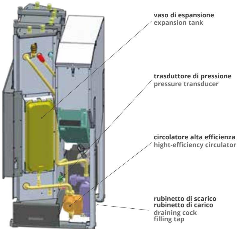
Il circolatore ad **alta efficienza a controllo elettronico** di serie, assicura massima flessibilità di installazione. Può essere tarato in base alle esigenze dell'impianto termoidraulico scegliendo direttamente dal display tra **4 impostazioni** che determinano la portata dell'acqua. Regola la quantità d'acqua immessa nell'impianto in base alla temperatura dell'acqua in caldaia. A prodotto spento, ma collegato alla rete elettrica si attiva settimanalmente per evitare blocchi.
