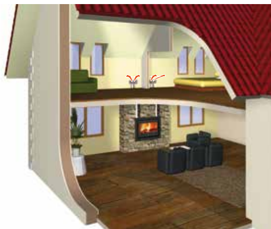
Ejemplo de canalización de aire caliente
